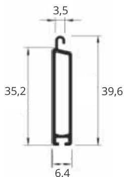
SL KU-N - Standard Endleiste für Rolläden Profile aus Aluminium
