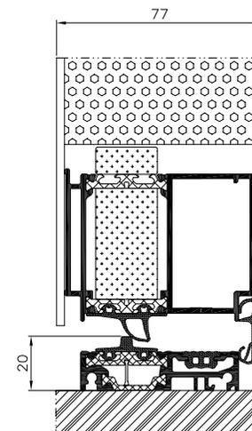
Alle im Angebot erhältlichen Modelle können durch Einsetzen zwischen zwei Profilen oder durch einseitiges oder doppelseitiges Kleben an den Profilen befestigt werden.
